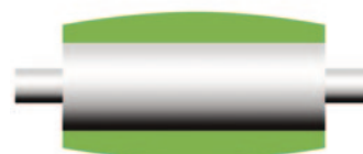
Acabado con bombeo parabólico
